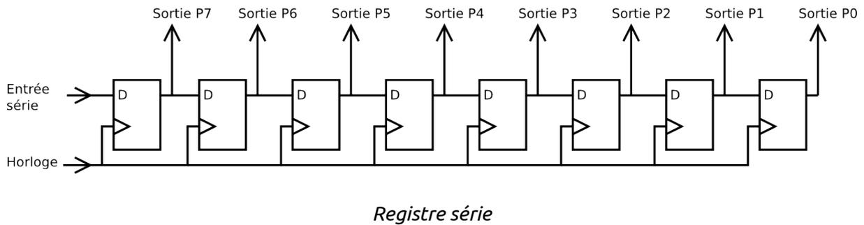
On y trouve 8 bascules D. Les horloges des 8 bascules sont reliées ensemble. L'entrée D de la première bascule est l'entrée de notre registre. Sa sortie est reliée à l'entrée de la seconde bascule et ainsi de suite. Le système a 8 sorties.
