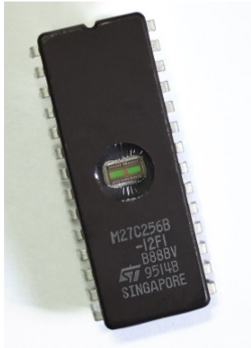
EPROM avec se fenêtre en quartz
