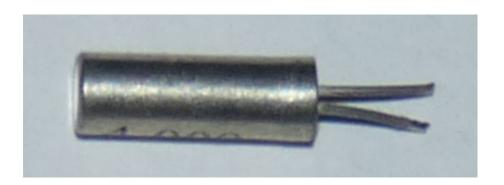
• 15 diviseurs par 2 vont permettre d'obtenir un signal de 1 Hz
